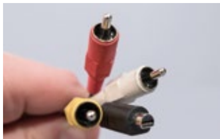
Kabel A/V może mieć półokrągły wtyk do gniazda w kamerze i trzy wtyki cinch (RCA). Żółty jest dla sygnału video, czerwony i biały do dźwięku.
